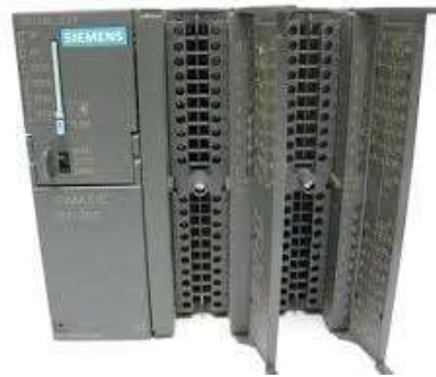
Figure 2.2A.P.I. modulaire de type Siemens S7-300.
