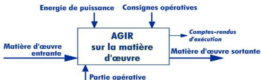
Figure 1.4. Schéma fonctionnel de la partie opérative.
