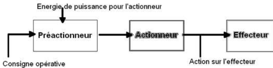
Figure 1.10 Schéma d'une chaîne d'action.
