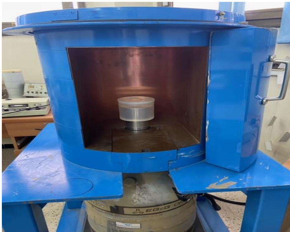
Figure 2.6 :Détecteur au Germanium hyper pur (Ge HP) utilisé dans CRND
