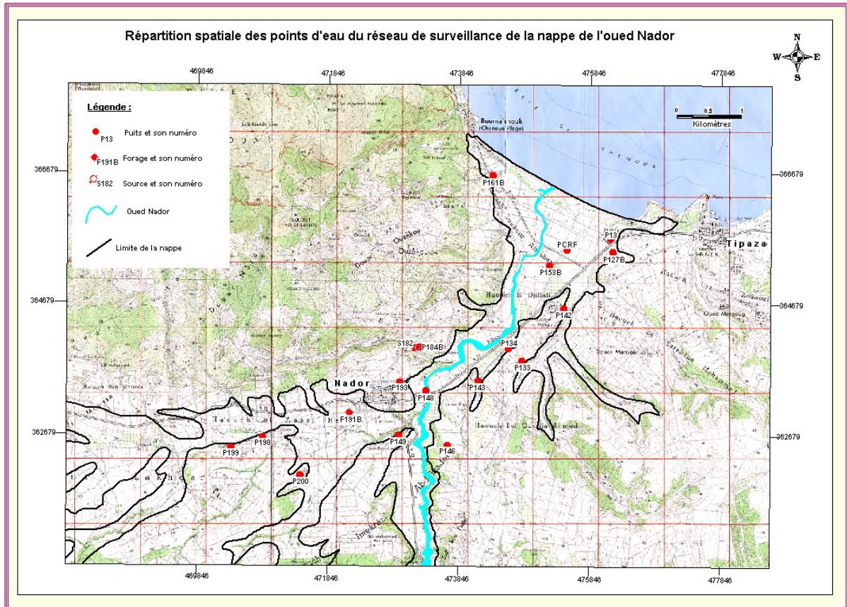
Fig.10. Carte de situation du réseau de surveillance de la nappe [6]
