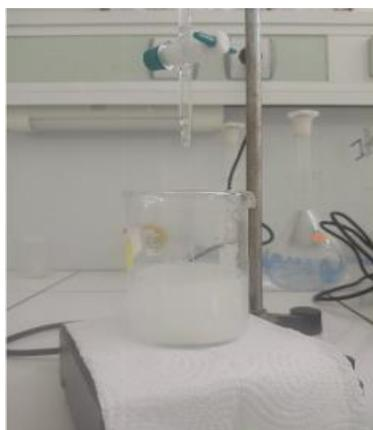
**Photo III.8 :** Titration pour détermination de l'indice d'ester.
