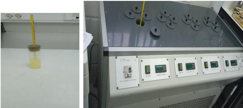
**Photo III.5 :** Appareil PENSKEY-MARTENS pour mesure le point d'écoulement
