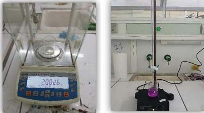
**Photo III.7:** Titrage colorimétrique.
