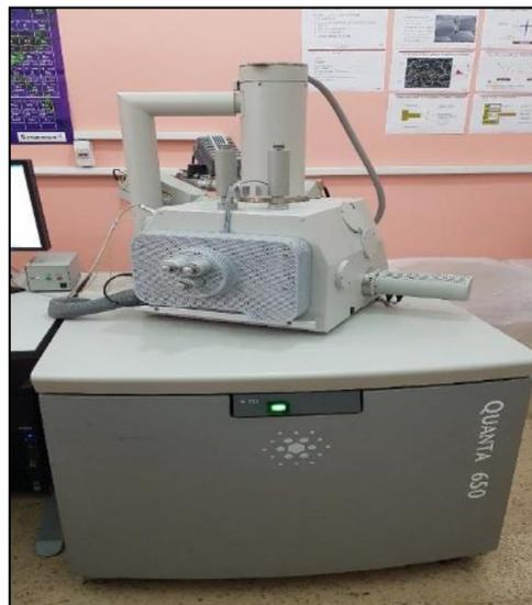
Figure II.4 : Appareil MEB couplé avec la spectroscopie EDX.
