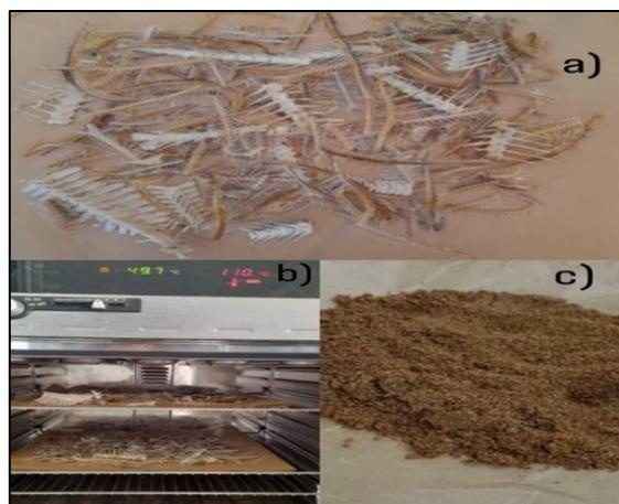
Figure II.1 : Processus de préparation de l'adsorbant : a) Lavage, b) Séchage et c) Broyage.
