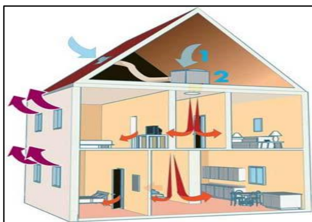
Fig14 Ventilation simple flux par soufflage
