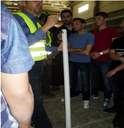
Figure V-7 : L'unité des filtres à cartouches, [ source: MESLEK.F].
