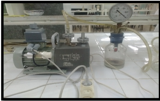
Cellule de filtration
