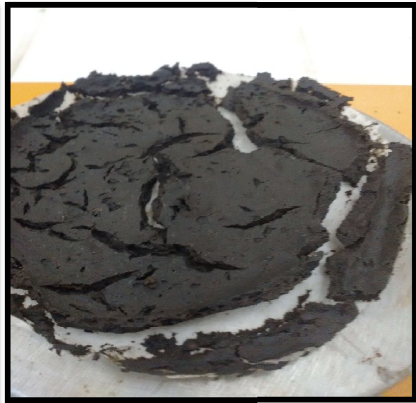
FeCl 3 +poudre naturelle de (OFI) (p=0,5bar, D=100g/kg FeCl 3 +2g/kg de(OFI))
