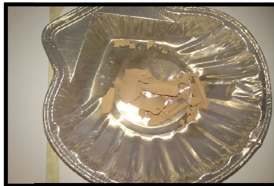
Figure.IV.4 : Photographie de la masse du gâteau sec (après calcination à 550 C°)
