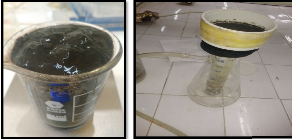
Figure.IV.9 : échantillon de boue conditionnée dans un b cher de 100 ml.
