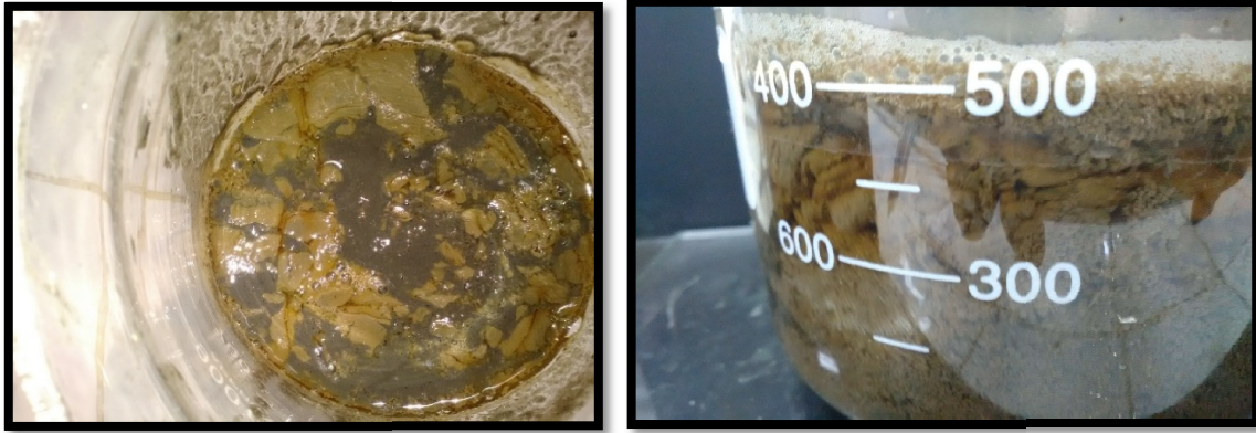
Figure.VI.17 : une boue conditionnée à une concentration de 10% et 9% MS de \text{FeCl}_3, 6\text{H}_2\text{O} au pH=12.
