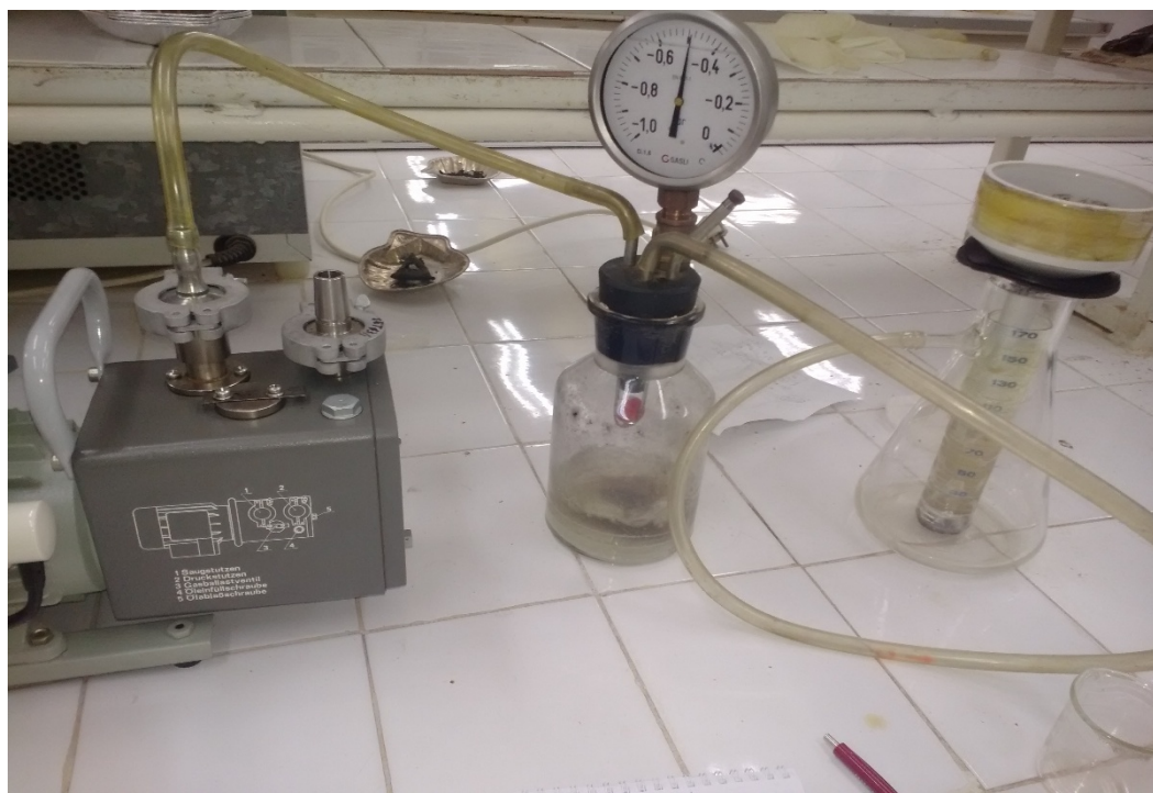
Figure.IV.8 : la cellule de filtration
