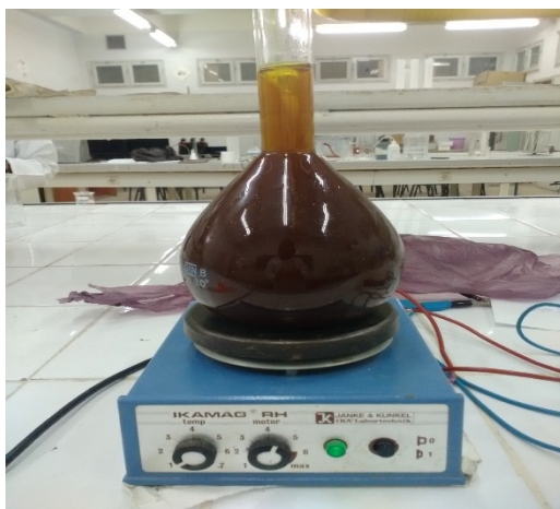
Figure : préparation de la solution mère de FeCl 3
