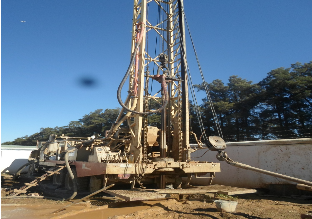
FigureIV.1: L'appareille de fonçage « méthode rotary »
