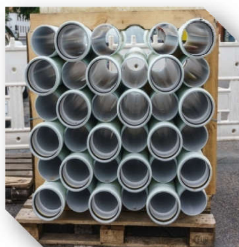
Figure IV.9 : Conduite en PVC
