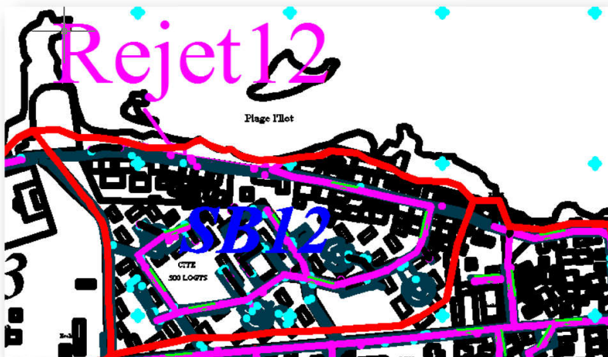
Figure V.12 : Réseau unitaire de SB12, Rejet 12
