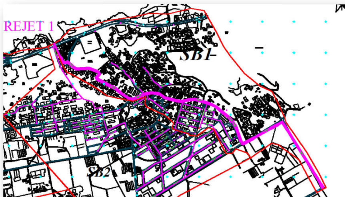
Figure V.1 : Réseau unitaire de SB1 , Rejet 1.
