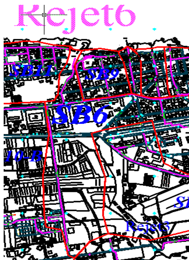
Figure V.6 : Réseau unitaire de SB6, Rejet 6.
