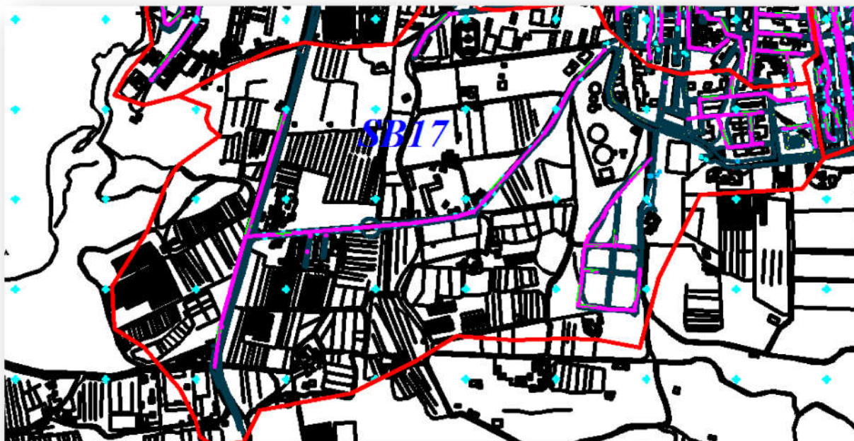
Figure V.14 : Réseau unitaire de SB17, Rejet 17.
