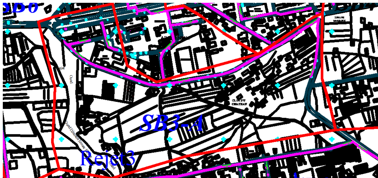
Figure V.3 : Réseau unitaire de SB3- A, Rejet 3
