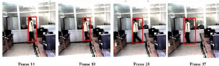
Figure 18. Résultats de suivi d'objet mobile utilisant l'estimateur à noyau contextuel Mean-shift [4]
