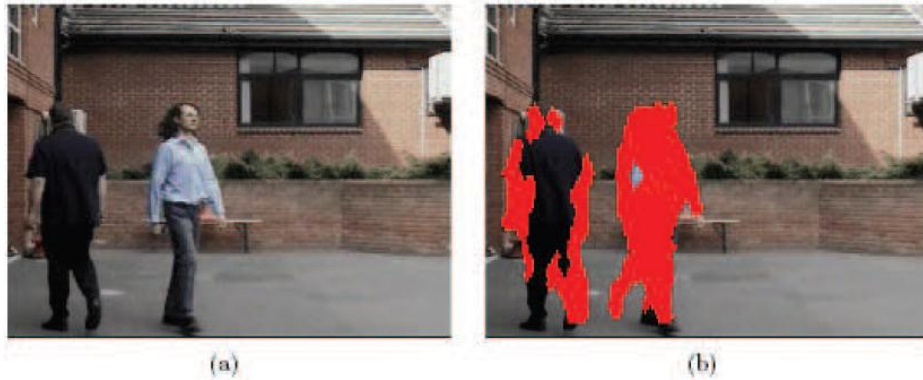
Figure 4. La différence temporelle : a) une scène avec deux objets en mouvement b) La différenciation échoue à détecter tous les pixels de l'objet à gauche (couleur uniforme). Les régions en mouvement sont marquées en rouge [6]
