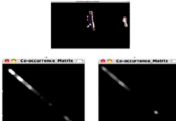
Figure 15. Deux matrices de cooccurrence calculées à partir des régions d'intérêts (objets en mouvement) après la génération des cartes de soustraction binarisées et étiquetées [4]
