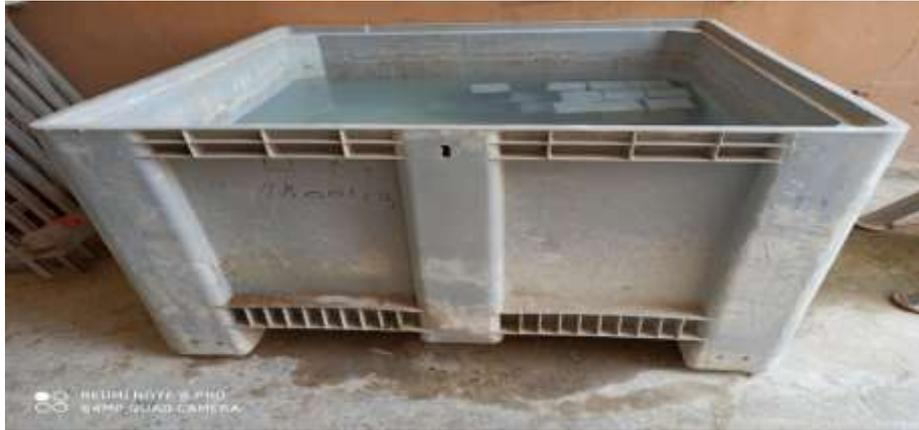
Figure IV.14 Bassin de conservation des éprouvettes.
