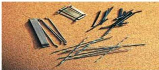
Figure II.3: Vue des fibres métalliques.
