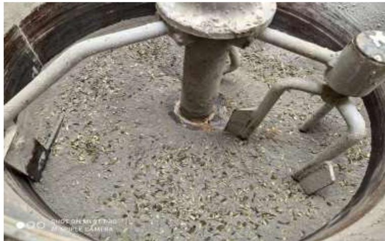
Figure IV.10 Cuve pour malaxer les matériaux.
