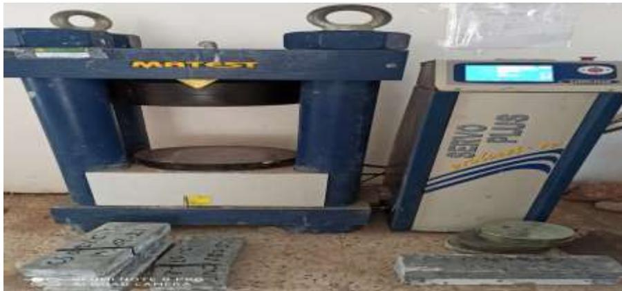
Figure IV.15 Machine de compression hydraulique.
