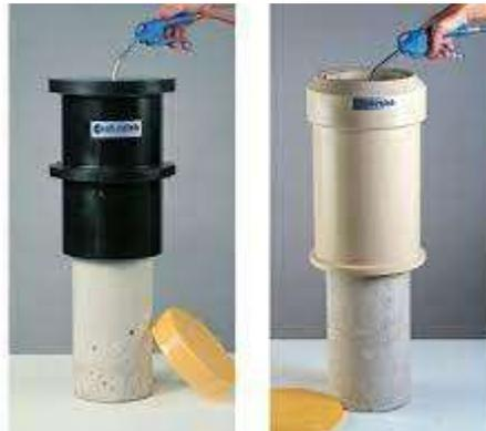
Figure III.10 : Démoulage des éprouvettes.
