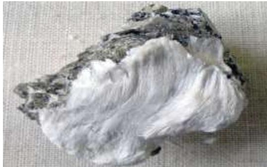
Figure II.4 : Vue de Fibres d'amiante.
