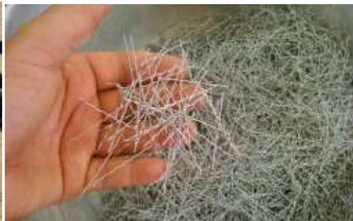
Figure III.1 : Fibres polypropylènes.
