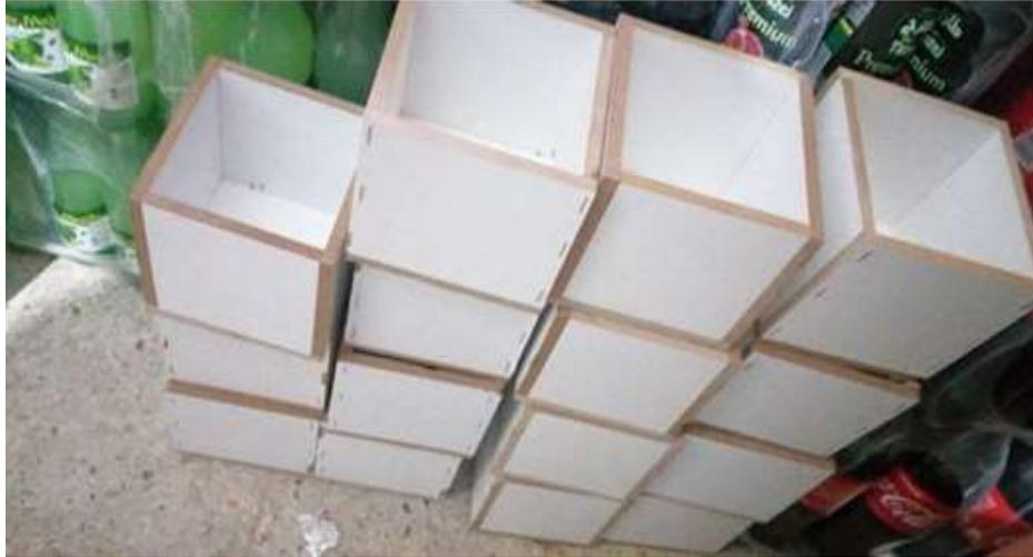
Figure IV.12 Les moules prismatiques de dimension  $10 \times 10 \times 10$  cm.
