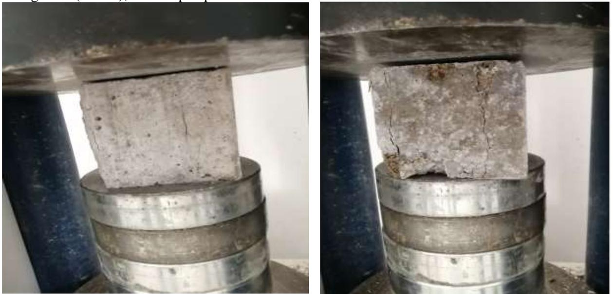
Figure V.1 : La fragilité de mortier non fibré.
