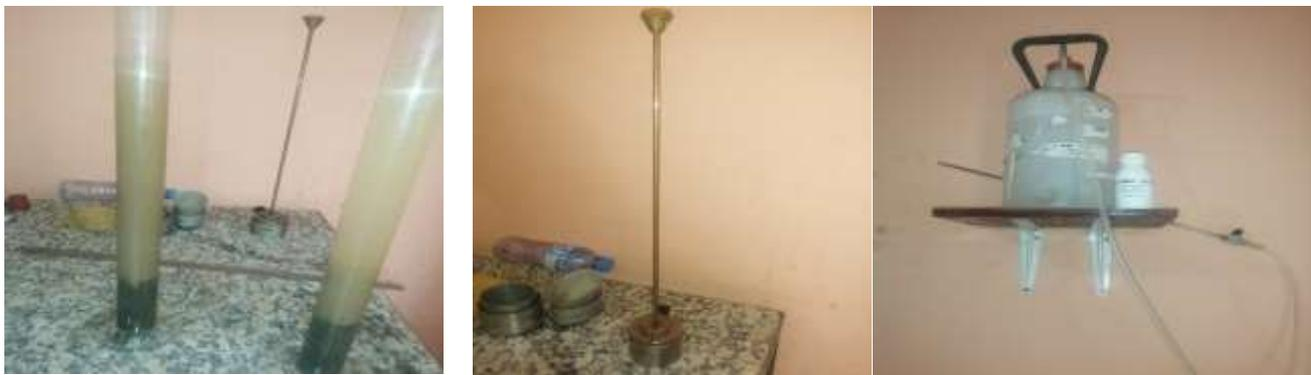
Figure IV.9 Matériel utilisé pour Mesure des particules fines.
