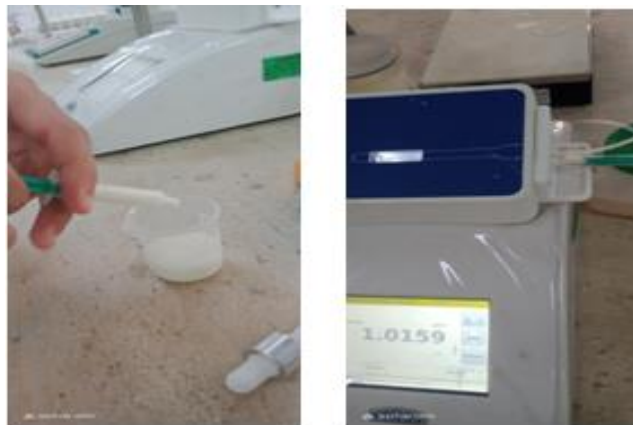
Figure V.5 : Mesure de la densité par un densimètre
