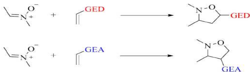
Figure I.5 : Influence de l'effet électronique sur la régiosélectivité des réactions de 1,3-DC.
