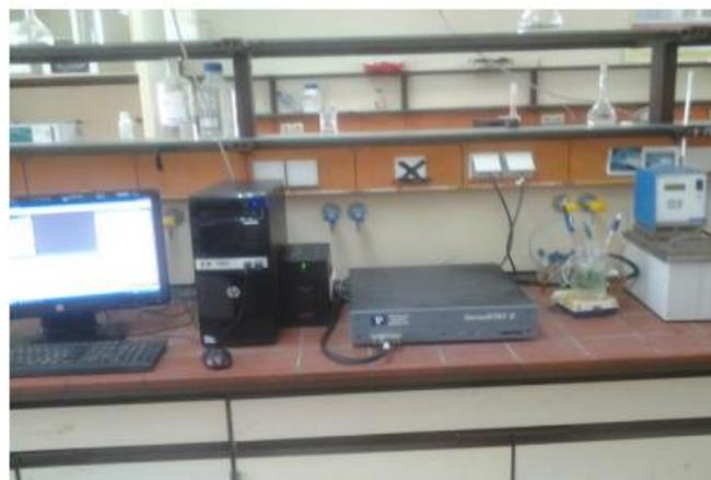
*Figure II.2: Montage électrochimique.*
