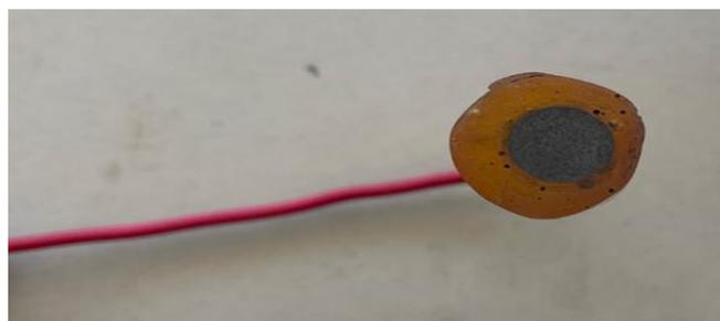
*Figure II.4 : Electrode de travail en graphite.*
