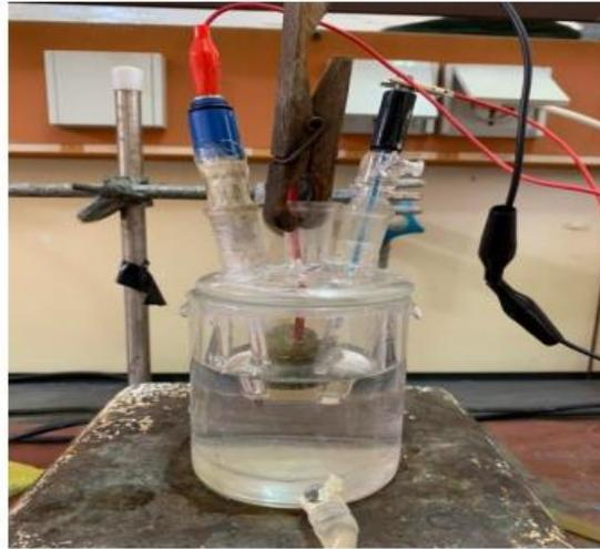
*Figure II.3 : Cellule électrochimique.*
