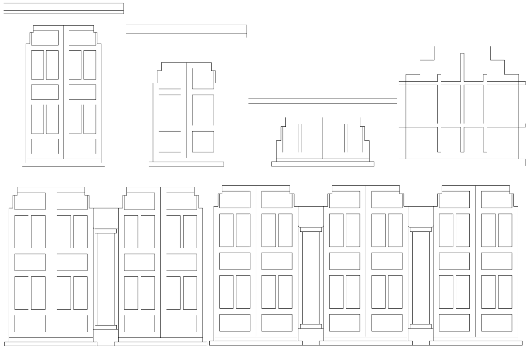
Figure.4.23 : Fenêtres du sous-sol, de différentes dimensions et multiples combinaisons. (Celles surmontées d'une plate-bande et celles assemblées par une ou deux colonnes).
