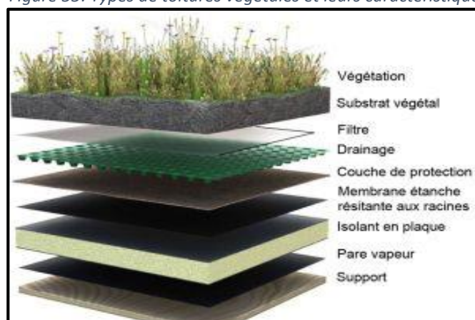
Figure 56: Composantes des toitures végétales.
