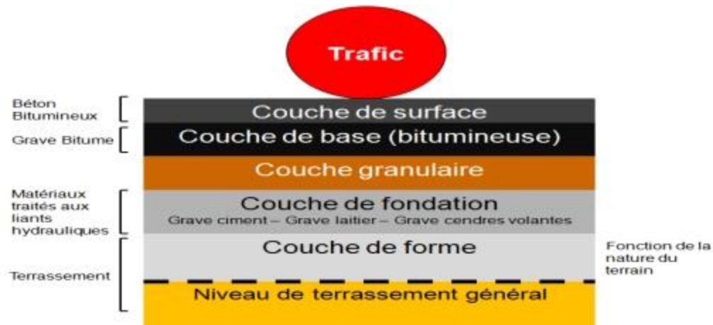
Figure I.9 : Couches d’une chaussée à structures inverses(6)
