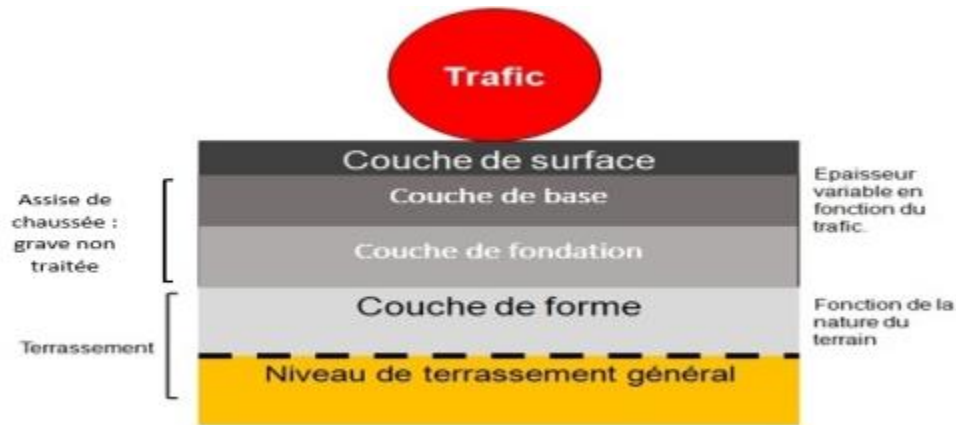
Figure I.5 : Couches d'une chaussée souple(6)
