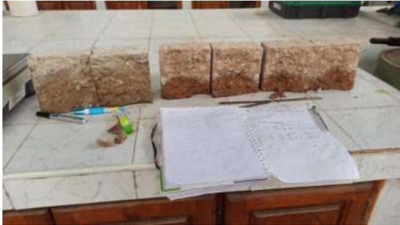
Figure III.27 : des éprouvettes écraser d'après essai traction par fendage pour mesurer la pénétration d'eau.
