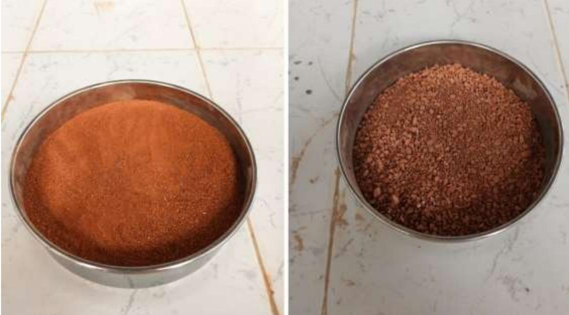
**Figure III.3** : Sable de brique fin et grossie.
