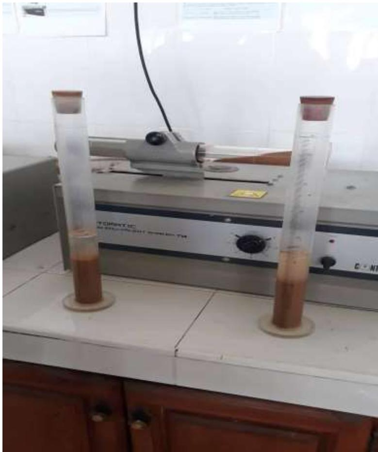
Figure III.7: Essai d'équivalent de sable.
