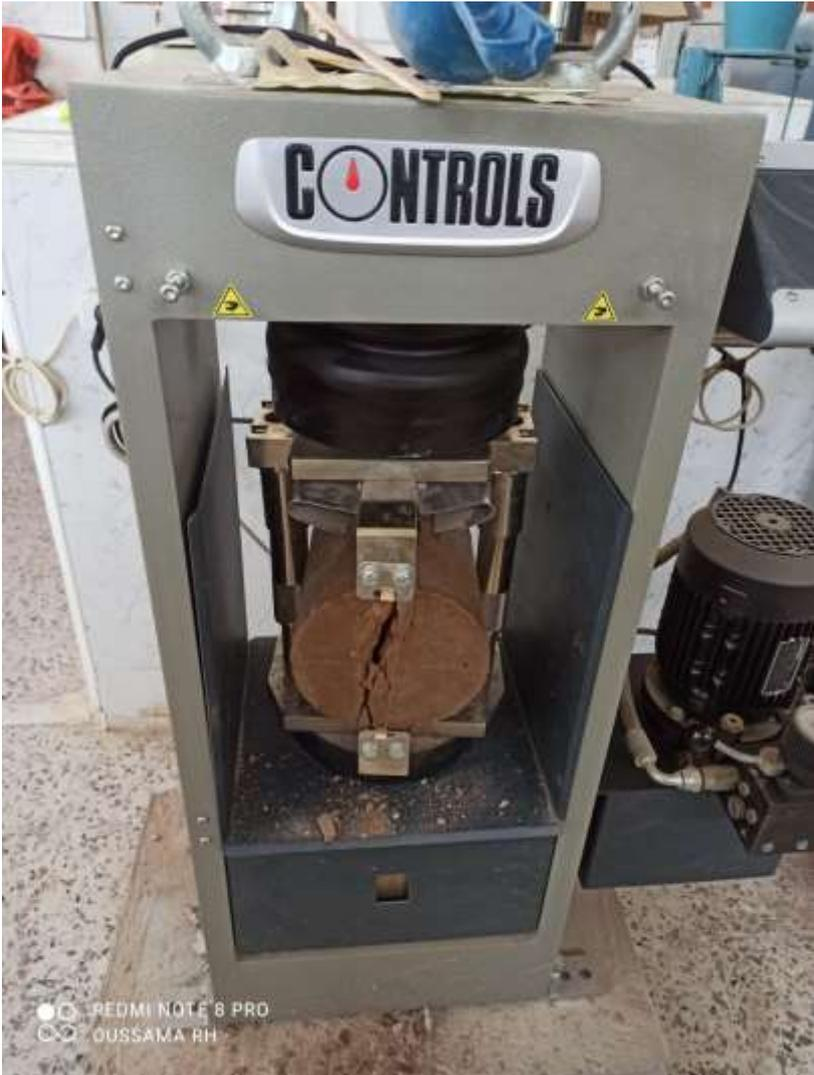
Figure III.24 : écrasement d'une éprouvette cylindrique par l'essai de traction par fendage.
