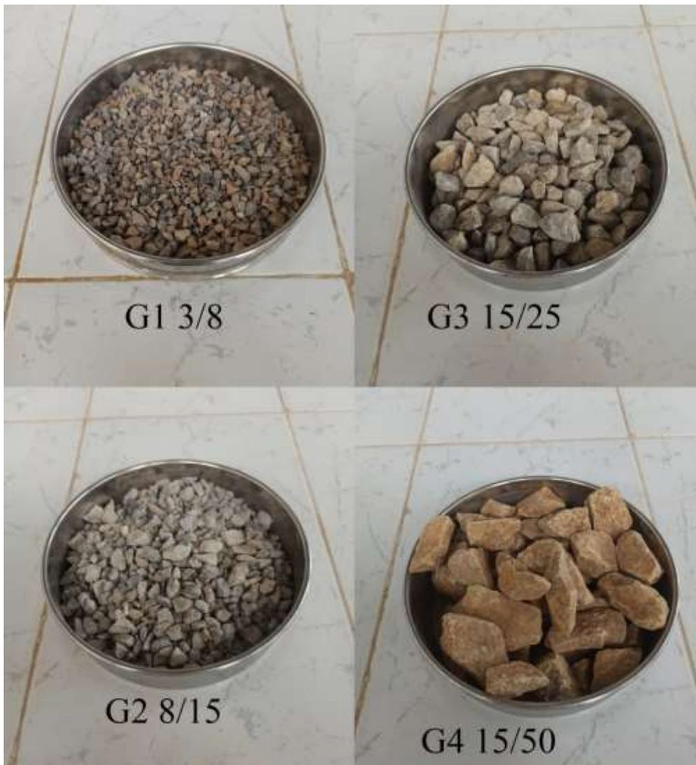
**Figure III.8:** Les graviers utilisés.
