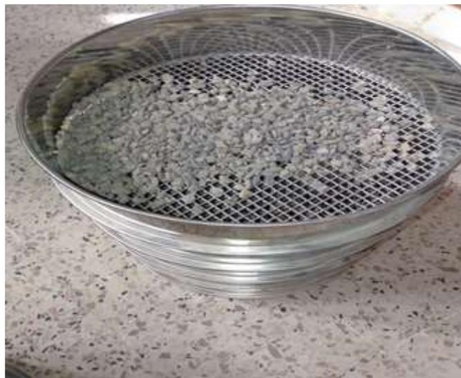
Figure III.10: Essai de la granulométrie d'un gravier
