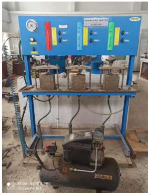
**Figure III.26** : Appareil de perméabilité.
