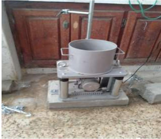
**Figure III.19:** Appareille VEBE
