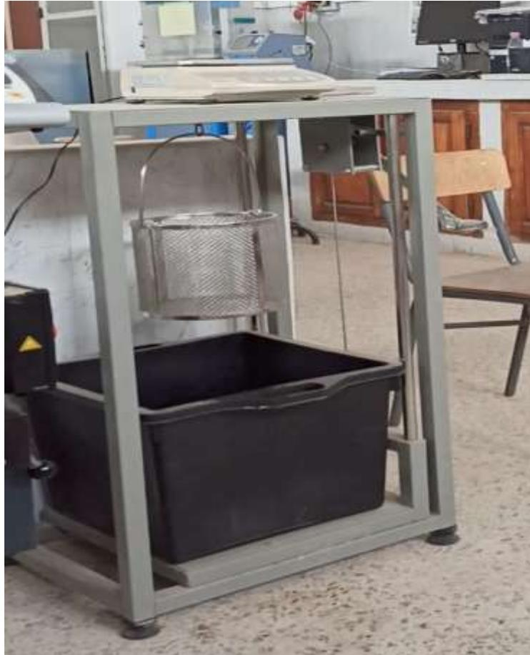
Figure III.29 : la pareille de porosité accessible a l'eau
