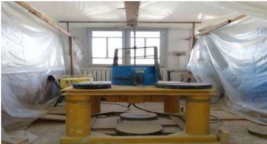
**Figure III.16 :** Appareil de compactage .
