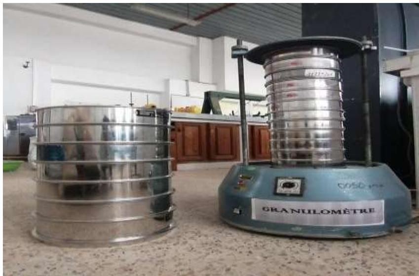
Figure III.5: l'appareil utiliser pour l'essai d'analyse granulométrique
