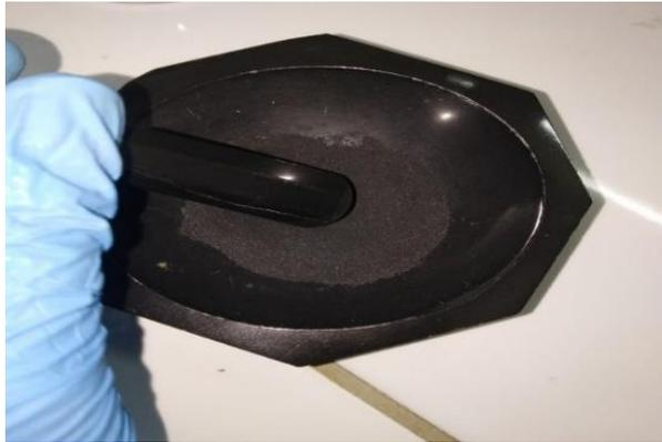
Figure 3.5 : Broyage de l'échantillon
