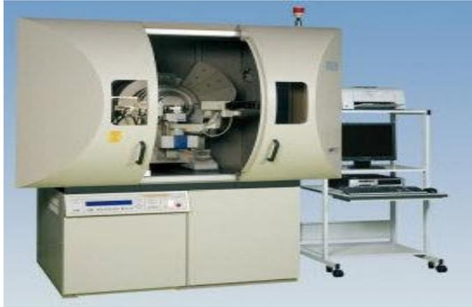
Figure 2.1 : l'appareil de diffraction des rayons X [33]
