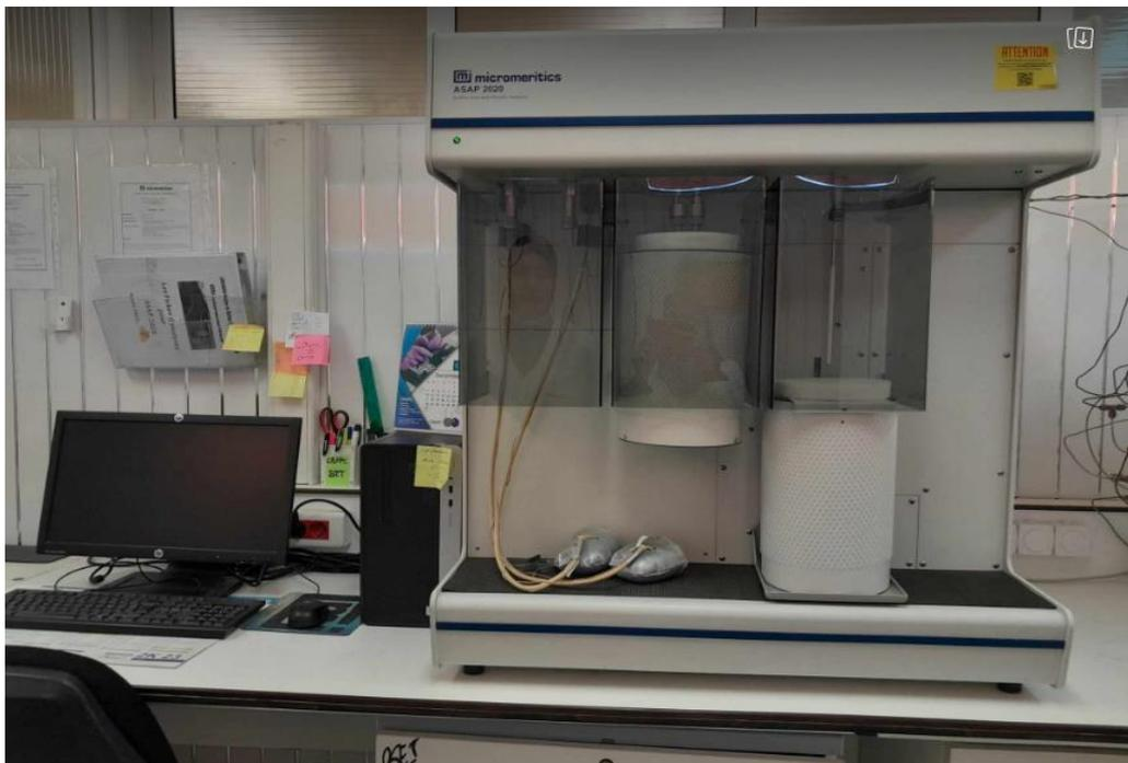
**Figure III.6 :** Analyseur de surface et porosité l'ASAP 2020 (CRAPC)
