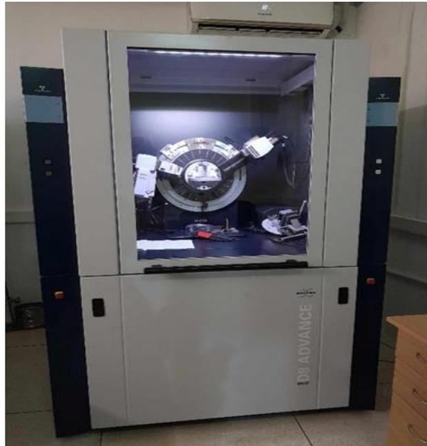
**Figure III.7 :** Représenté un Diffractomètre « Bruker D8 » (CRAPC)
