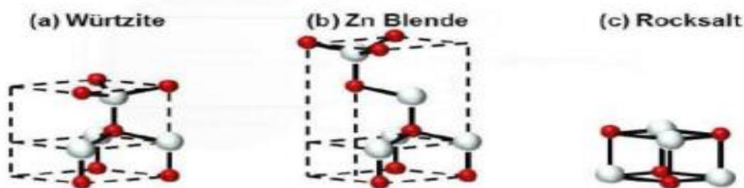
Figure I.8 : Structures cristallines possibles du ZnO [43].
