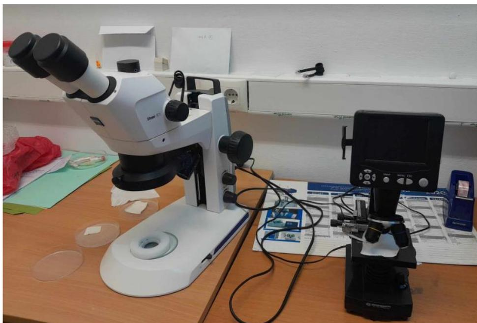
**Figure III.3 :** Loupe optique Stemi 350 (CRAPC)
