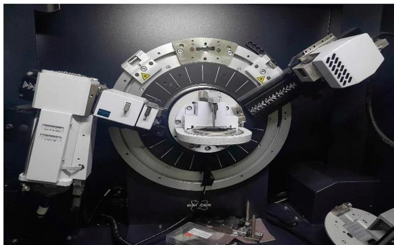
**Figure III.9 :** plans réticulaires d'un diffractomètre (Bruker D8 ADVANCE) (CRAPC)
