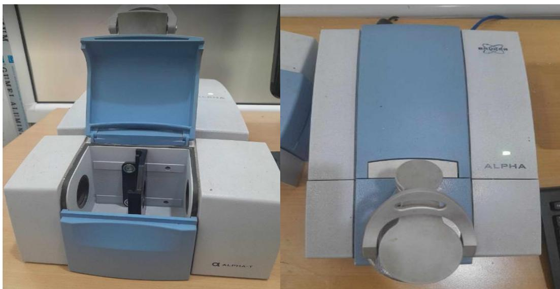
**Figure III.10** : appareil de IRTF (Infra Rouge à Transformée de Fourier) (CRAPC).
