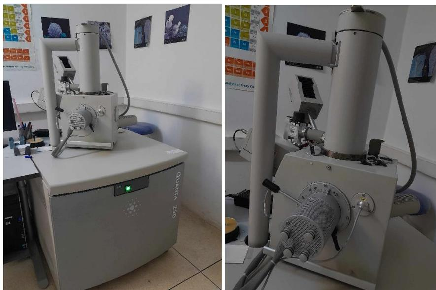
**Figure III.4 :** Appareil de MEB couplé à l'EDX « FEI Cutomer Owrshir » (CRAPC)
