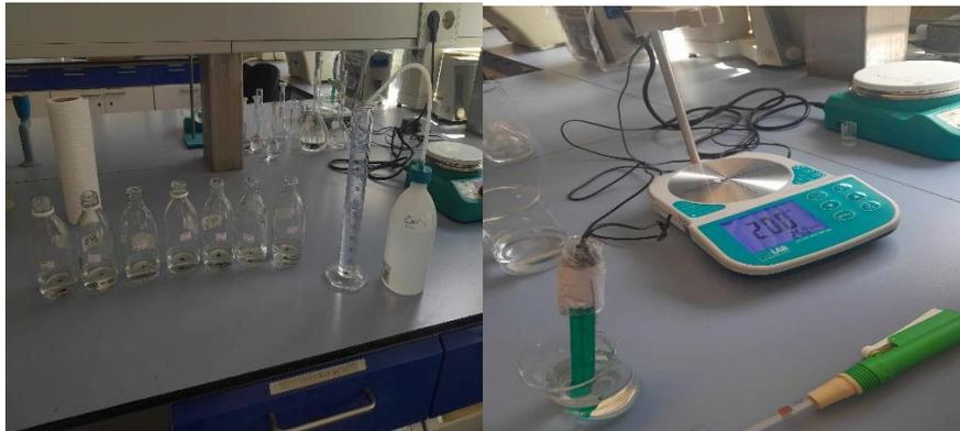
**Figure III.13 :** représenter la préparation d'une série des solutions avec différents pH initial. (CRAPC).
