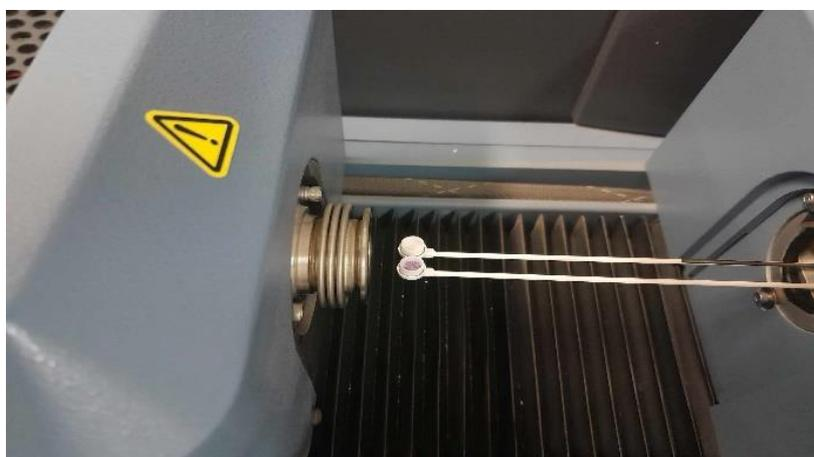
**Figure III.16** : la canne de mesure de modèle Perkin Elmer STA6000 (CRAPC)
