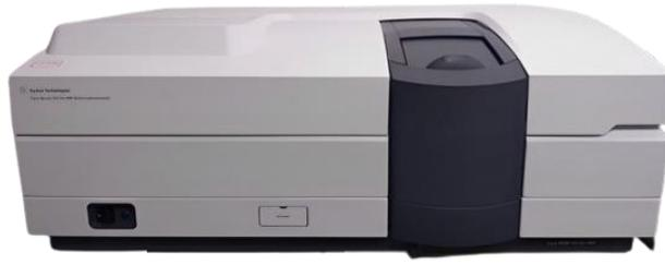
Figure II.12 : Spectrophotomètre UV-Vis Agilent de type Cary 5000 UV VIS NIR.
