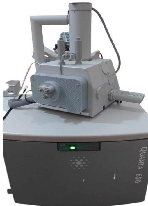
Figure II.7 : Microscope électronique à balayage (MEB)
