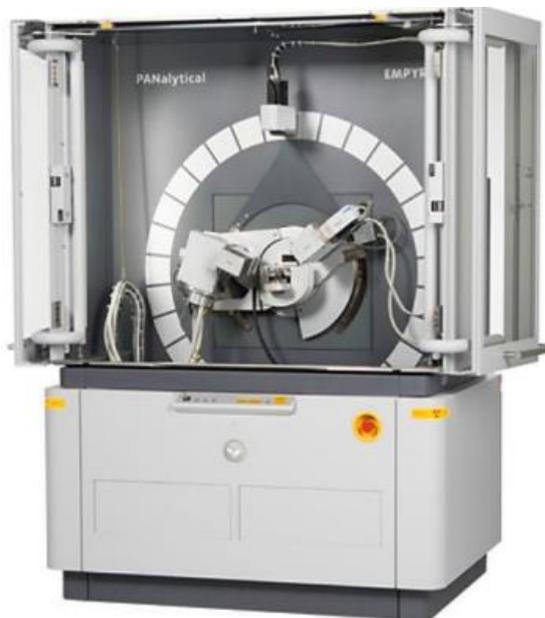
Figure II.3 : Diffractomètre de type PANALYTICAL EMPYREAN.
