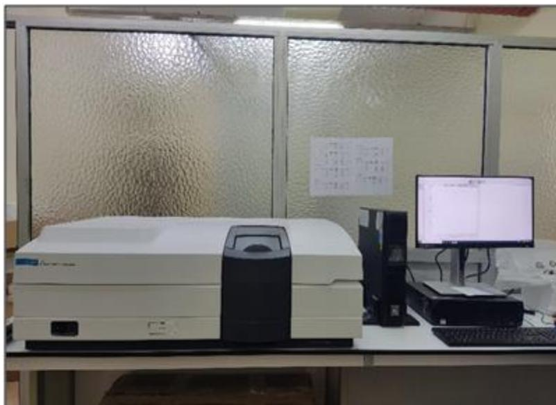
Figure II.8 : Spectrophotomètre UV-Vis Agilent de type Cary 5000 UV VIS NIR.
