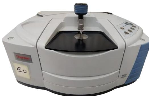
Figure II.5 : Spectromètre (FTIR) de marque THERMO SCIENTIFIC type (Nicolet s10)
