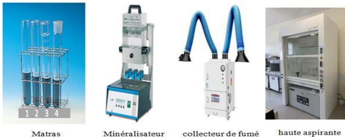
Figure II.8 : Appareillage utilisée pour la détermination de taux de protéine [21]
