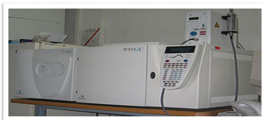
**Figure 29:**L'appareil GC-MS.
