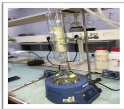
**Figure 30:**L'extraction des alcaloïdes par soxlet.
