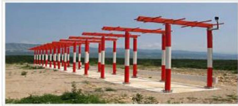
**Figure 4.2 :** Antennes du système LOCALIZER
