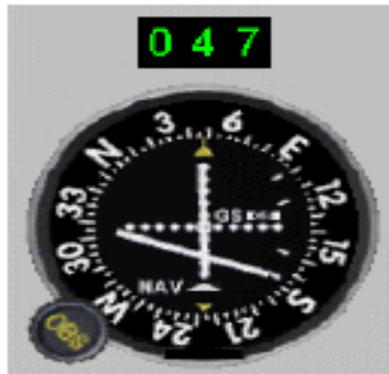
Figure 4.22 : la barre horizontale indique au pilote d'effectuer une correction vers le bas
