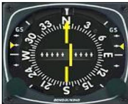
**Figure 4.13** : la barre verticale indique qu'il faut effectuer une correction vers la droite
