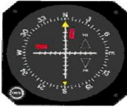
**Figure 4.11** : les barres sont centrées sur l'écran de l'instrument
