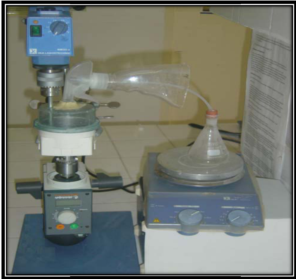
Figure 2.3 : Schéma du mélangeur-granulateur conçu [3].
