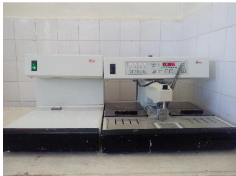
Station d'enrobage de marque Leica (Leica EG 1150 H)
