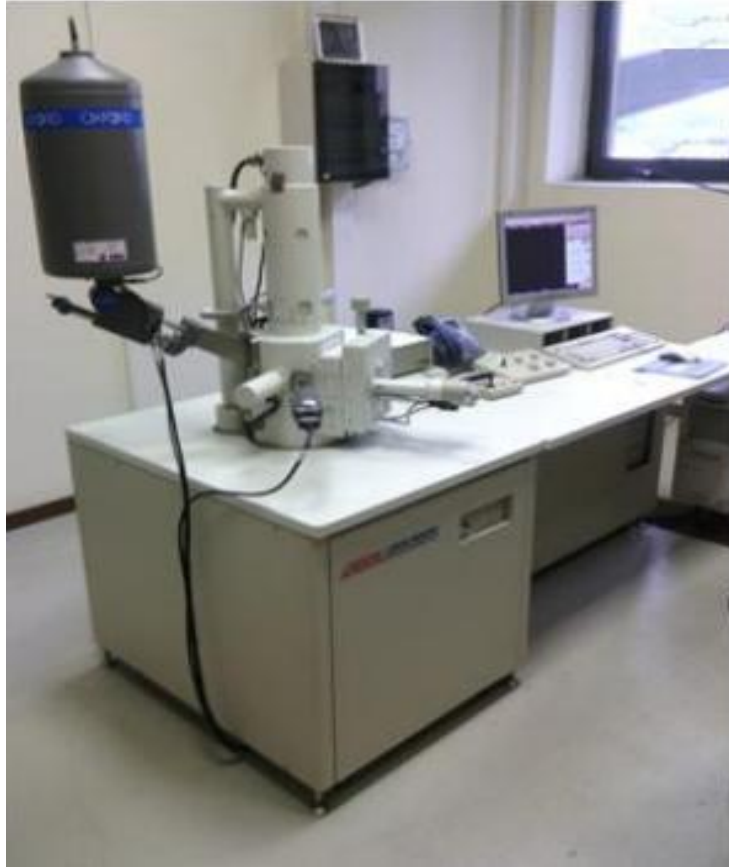
Figure II. 4. Microscopie électronique à balayage MEB de type JEOL JSM-5600
