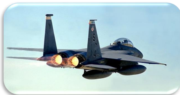
Figure (1.3) : Tuyère supersonique d'un avion de combat [21].
