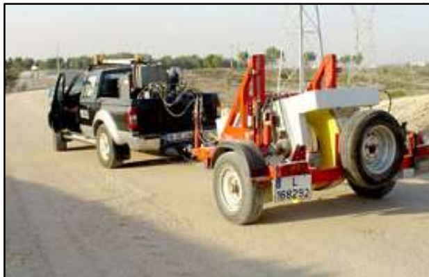
Figure I. 5: photos montrant essai au portancemètre .
