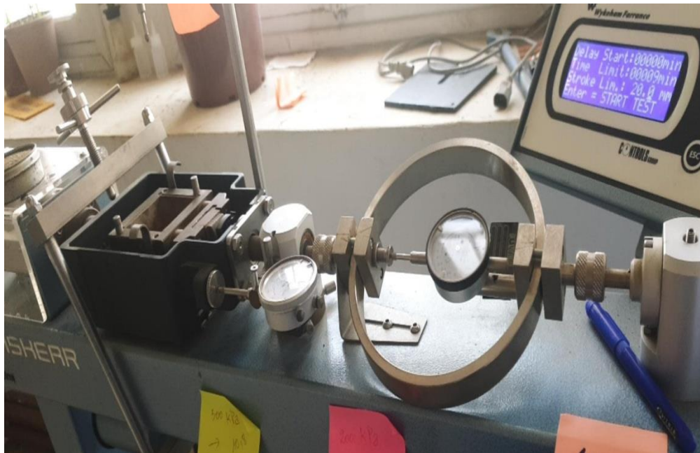
Figure 2. 2: Eléments constituant l'appareil de cisaillement
