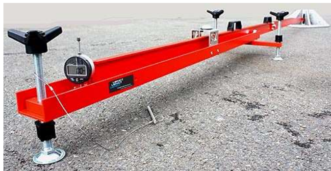
Figure I. 3: photos montrant essai à la outre Benkelman .
