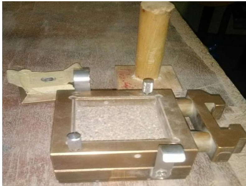
Figure 2. 10: Méthode de la pluviation à sec
