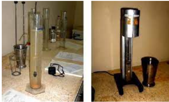
Figure II. 13: Granulométrie par sédimentométrie (Eprouvette et agitateur).
