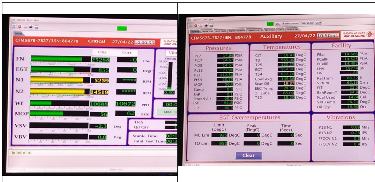
Figure III-5: les données qu'on a vue dans le banc d'essai en régime Décollage.
