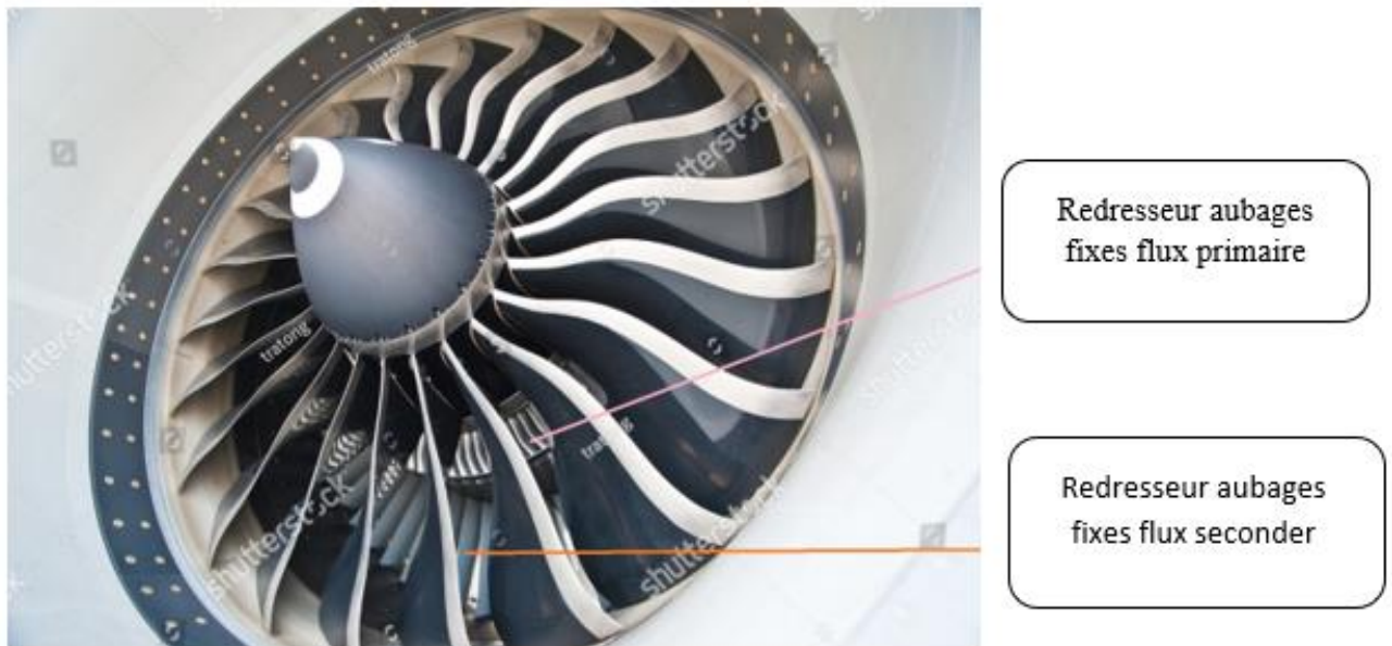
Figure I-6: La soufflante « FAN »
