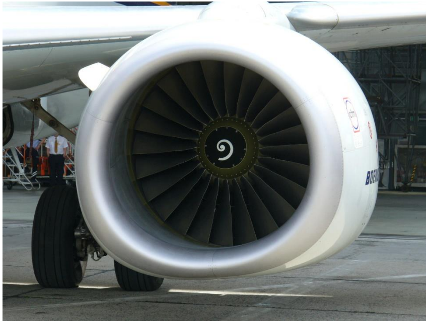
Figure I-5: entre d'air « diffuseur »
