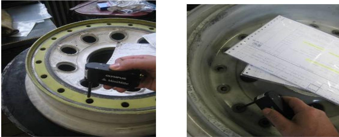
Figure II-II.4: Inspection du demi attaché de la jante avec boulons
