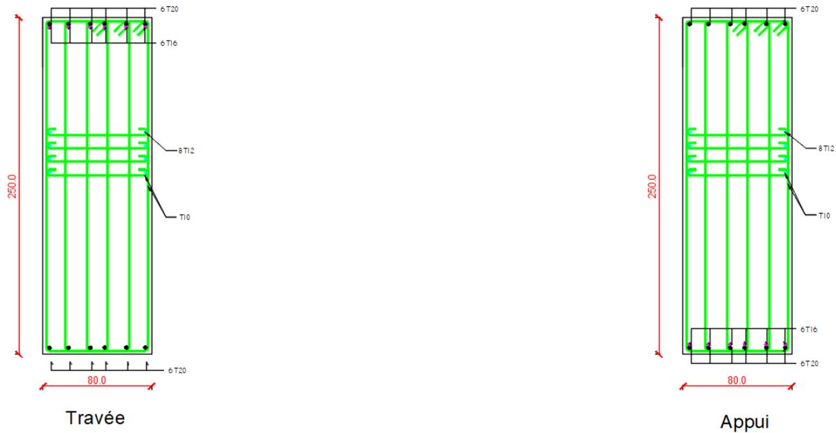
Figure 6.9: Ferrailage des nervures du sens non porteur.
