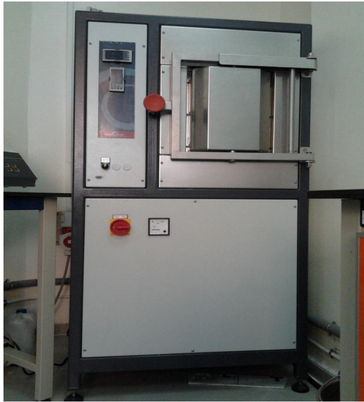
Figure II-10 : four électrique de traitement thermique
