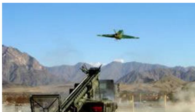
Fig.I.13. Catapultage opérationnel d'un drone Sperwer en Afghanistan.
