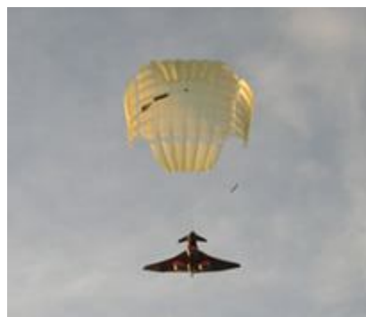
Fig.I.11. Récupération par parachute d'un Sperwer.
