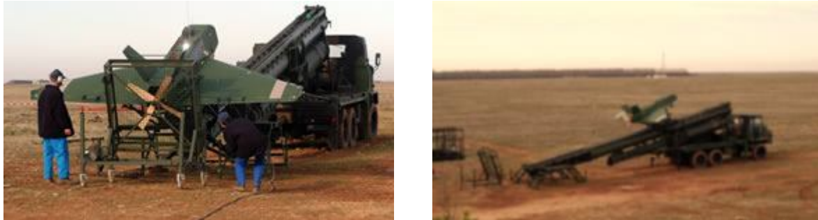
Fig.I.10. Phase de lancement sur catapulte d'un drone SDTI.
