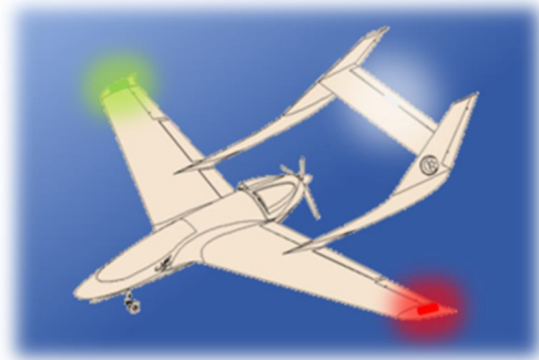
Fig.II.35 : L'éclairage du drone.
