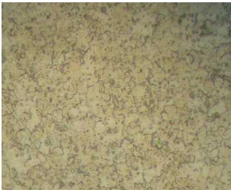
*figure4-2-9* Micrographie de TA6V à 750c<sup>0</sup> (4h) \*500
