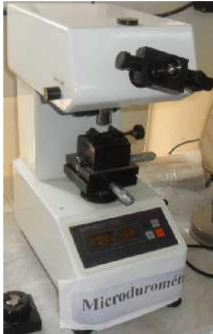
Figure3-3 L'appareil de test de microdureté
