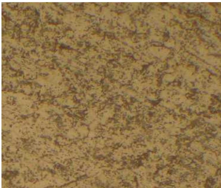
*figure4-2-5* Micrographie de TA6V à 550c<sup>0</sup> (4h) \*500
