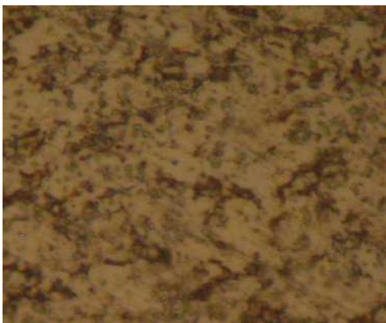
*figure4-2-6* Micrographie de TA6V à 550c<sup>0</sup> (4h) \*1000
