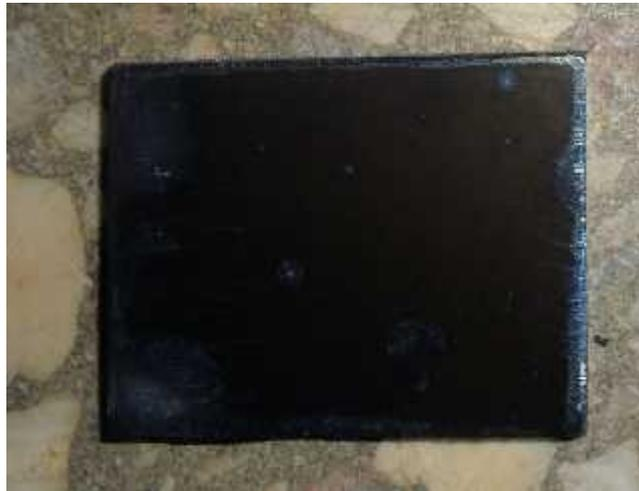
*Figure3-8 échantillon traité à  $750^{\circ}\text{C}$  pour 4h de maintien*
