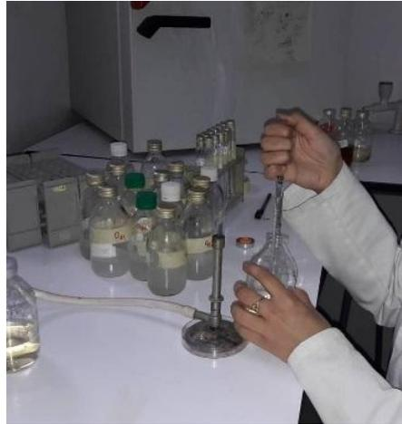
**Figure 05** : La préparation des dilutions décimales (photo originale).
