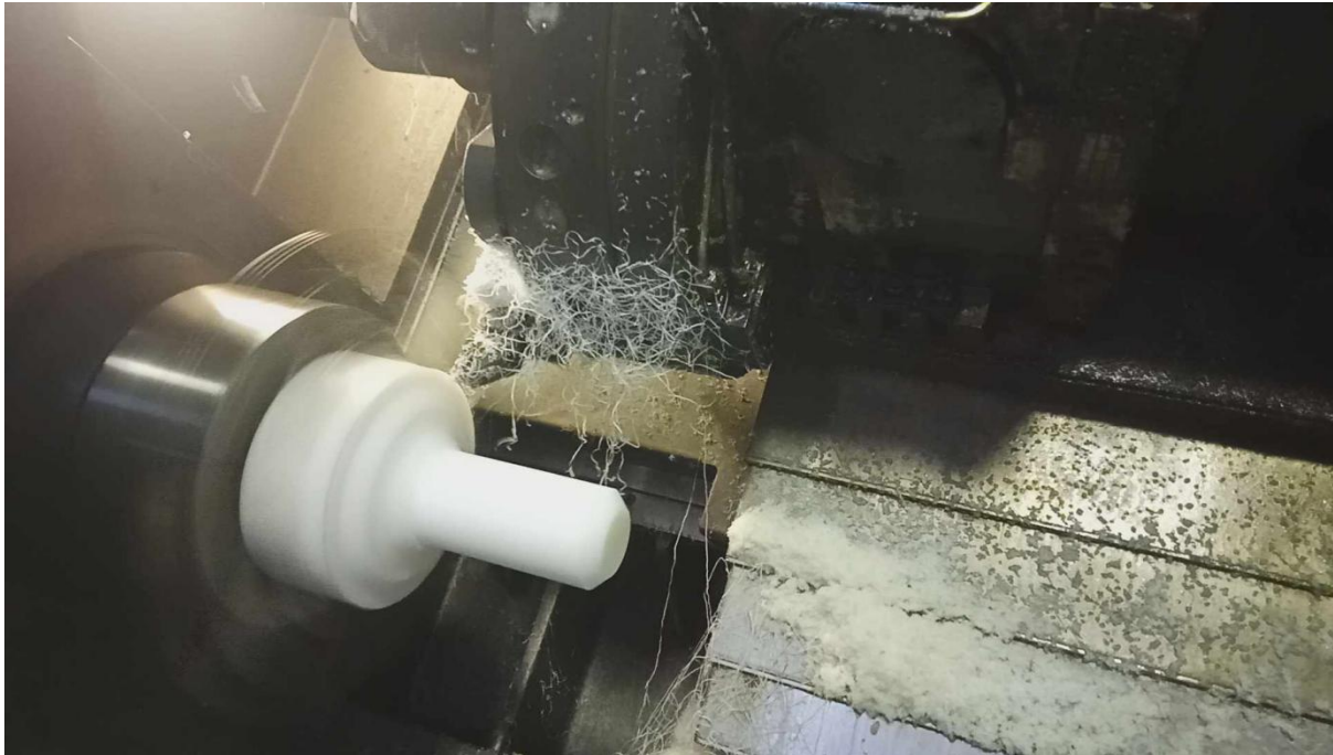
Figure 74 : Finition de la pièce
