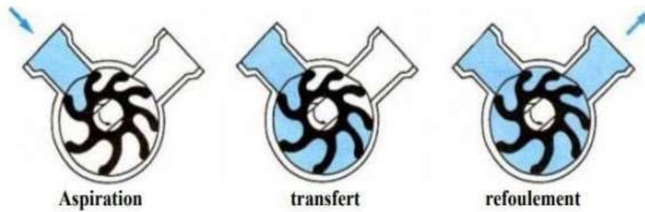
FIGURE 1.13 - Pompes à palettes flexibles
