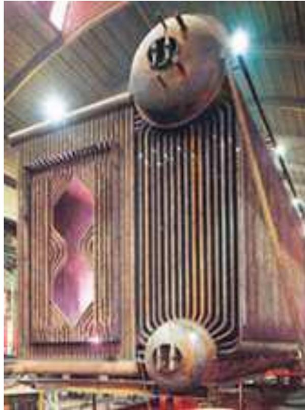
**Figure II.2 vue extérieur d'une chaudière a tubes d'eau [3]**
