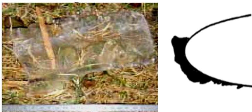
FIG I.3 Formation de verglas sur un profil d'ail [19].
