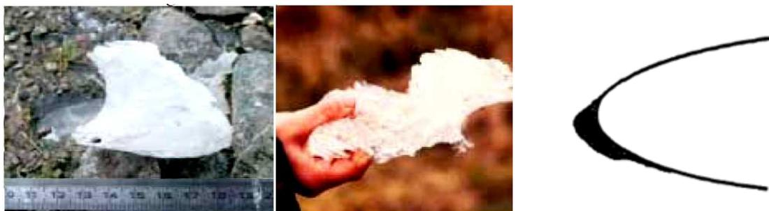
FIG I.2 Fragment de glace de givre d'une lame de rotor trouvée au sol. [19].
