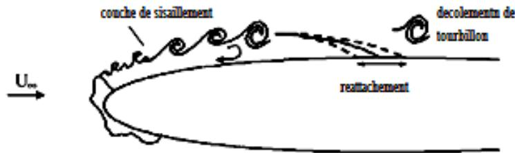
FIG III.5 Instabilité de l'écoulement autour d'un profil avec accumulation de glace.
