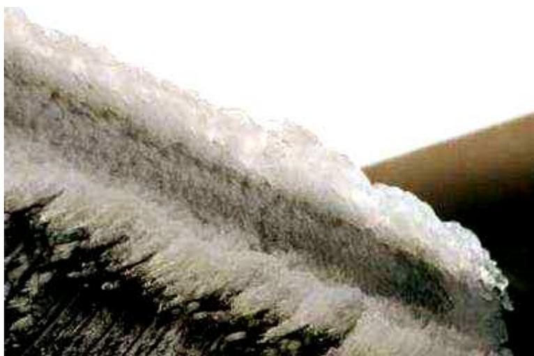
FIG I.1 Accumulation de glace sur une aile d'avion (Tailplane Ice on Twin Otter Flight, 1992).
