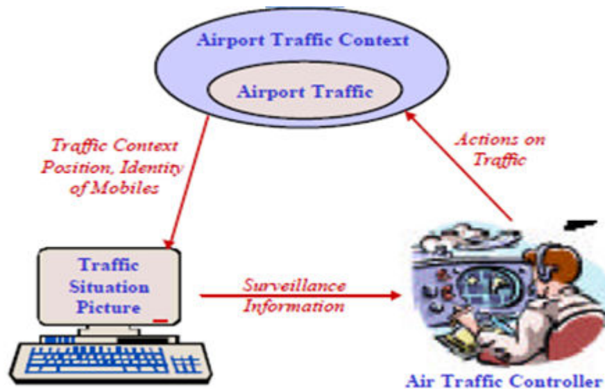
Figure III.5 : Principe de fonctionnement du niveau I
