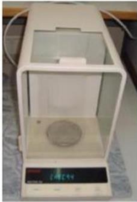
Figure.II.10 : Balance de précision de marque OHAUS
