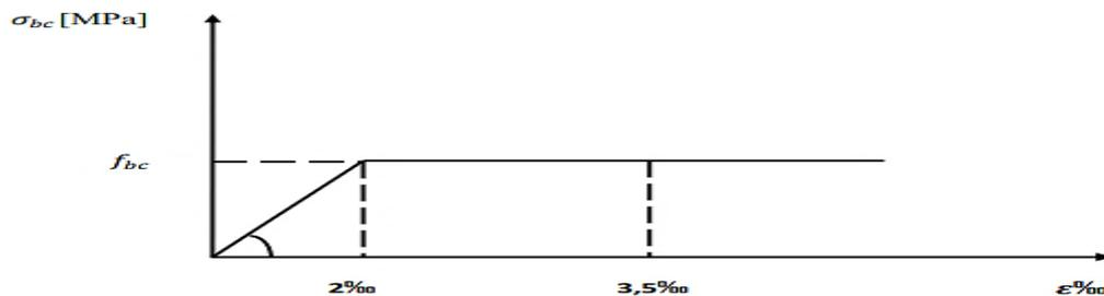
Figure I.2: Diagramme contrainte déformation du béton à l'ELS
