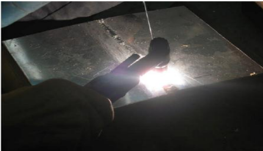
Figure. II.2: Application et influence de la vitesse de soudage TIG [13].
