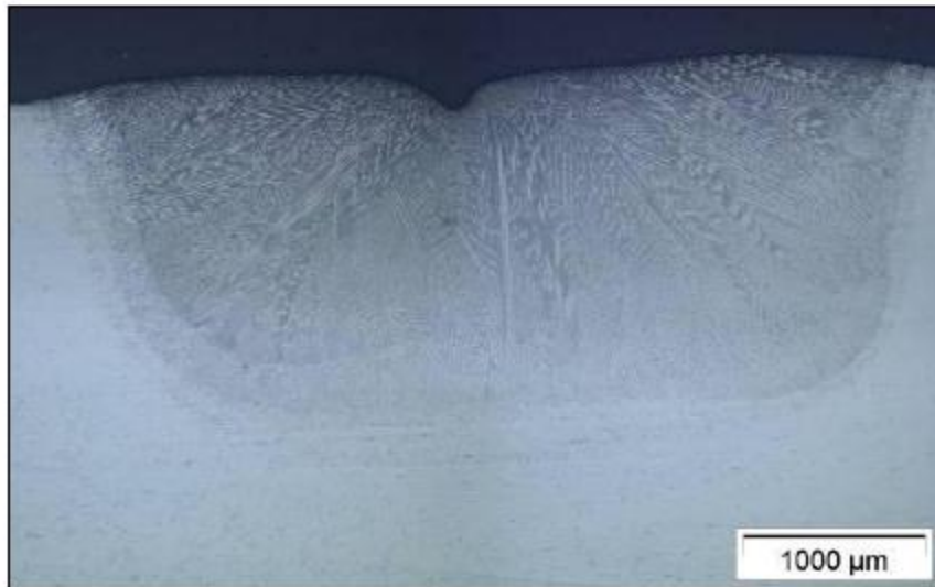
Figure II-10 : Déformation résiduelle de la surface soumise à la pression d'arc observée lors d'un essai TIG sans déplacement de la torche.
