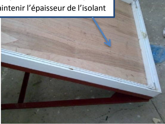
Réalisation de la couche sélective de la plaque absorbante
