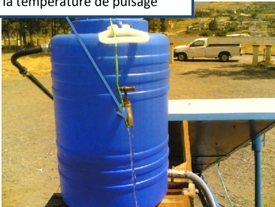
Cuve de stockage avec thermocouple pour la température de puisage
