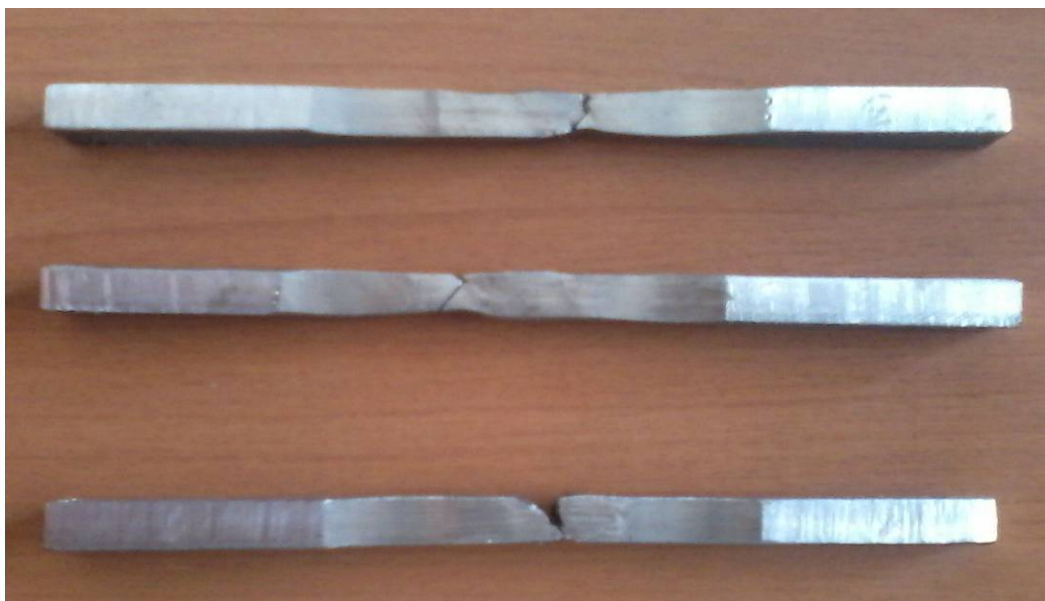
Figure IV.11 . Zone de rupture des éprouvettes E1, E5, et E3
