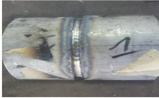
Figure IV.4 : Cordon TIG de l'échantillon N°1
