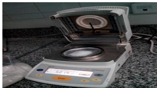
**Figure II-4**: L'opération de mesure de l'humidité
