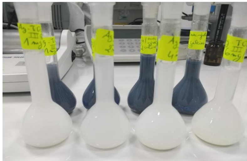
Figure III.3 : Solutions préparées pour l'étude de l'effet antibactérien et antifongique des NPs de TiO 2 et des nanocomposites d'Ag-TiO 2
