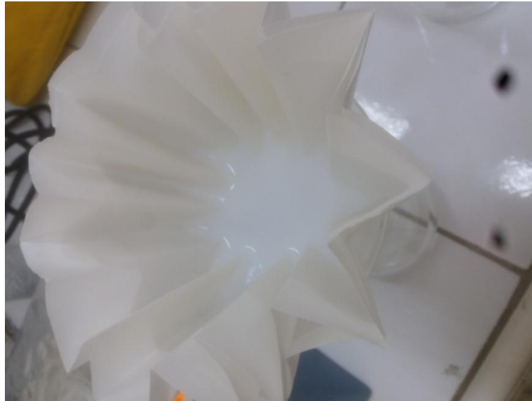
Figure III.1 : Formation du gel d'hydroxyde de titane hydraté \text{Ti}(\text{OH})_4 .
