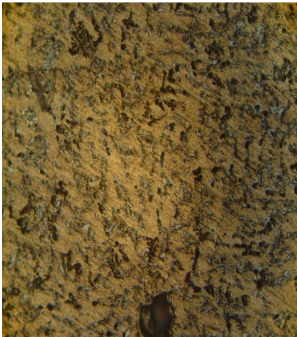
FigureV.12.a : Microstructure de l'alliage Cu2 Avec T.T à 470°C trempée à 100°C (90HB) X200
