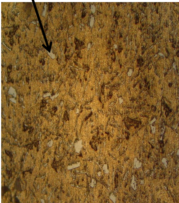
FigureV.8.a : Microstructure de l'alliage Si3 Avec T.T à 490°C trempée à 100°C (78HB) X200
