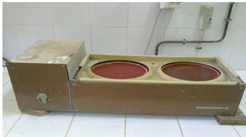
Figure IV.11 : Appareil de polissage abrasion.
