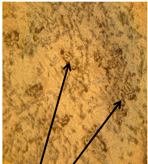
FigureV.17.b : Microstructure de l'alliage Si11Cu2 avec T.T a 500°C trempée à 30°C (80HB)
