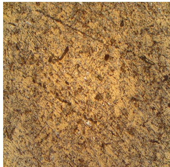
FigureV.15.b : Microstructure de l'alliage Si11Cu2 avec T.T a 500°C trempée à 30°C (80HB)
