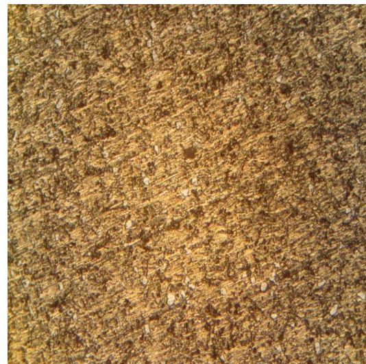
FigureV.7.b : Microstructure de l'alliage Si3 avec T.T à 470°C trempée à 30°C (96HB) X100
