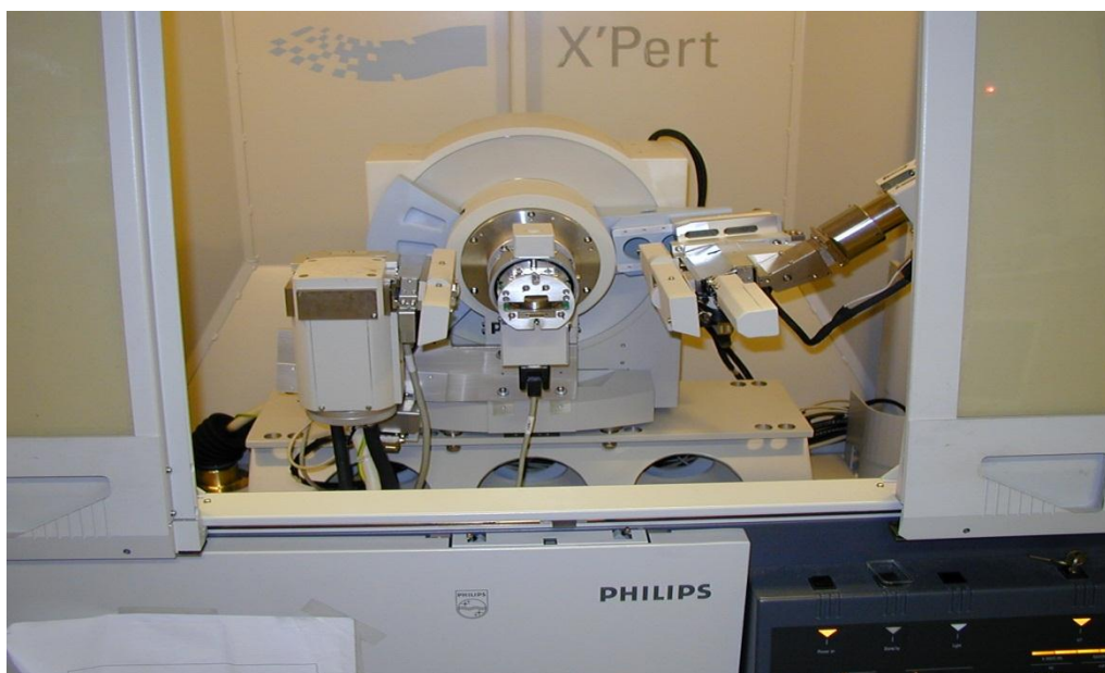
Figure IV.17 : diffractomètre de type Bragg-Brentao de marque Philips X-Pert Pro (CRNA)
