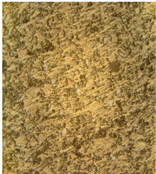
FigureV.8.b : Microstructure de l'alliage Si3 avec T.T à 470°C trempée à 30°C (96HB) X200
