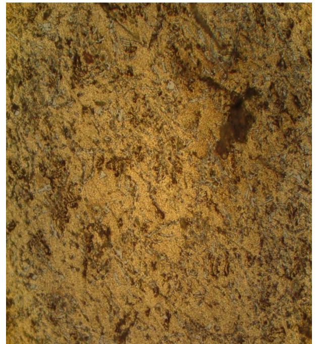
FigureV.16.b : Microstructure de l'alliage Si11Cu2 avec T.T a 500°C trempée à 30°C (80HB)
