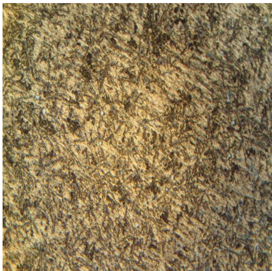
FigureV.15.a : Microstructure de l'alliage Si11Cu2 Avec T.T à 480°C trempée à 100°C (59HB)
