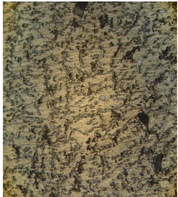
FigureV.12.b : Microstructure de l'alliage Cu2 avec T.T a 490°C trempée à 60°C (106HB) X200
