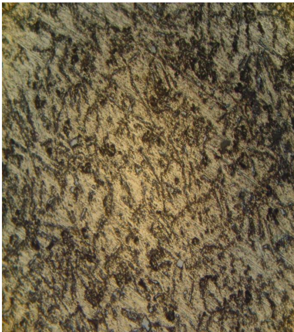
FigureV.16.a : Microstructure de l'alliage Si11Cu2 Avec T.T à 480°C trempée à 100°C (59HB)
