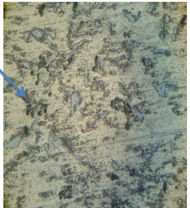
FigureV.13.b : Microstructure de l'alliage Cu2 avec T.T
