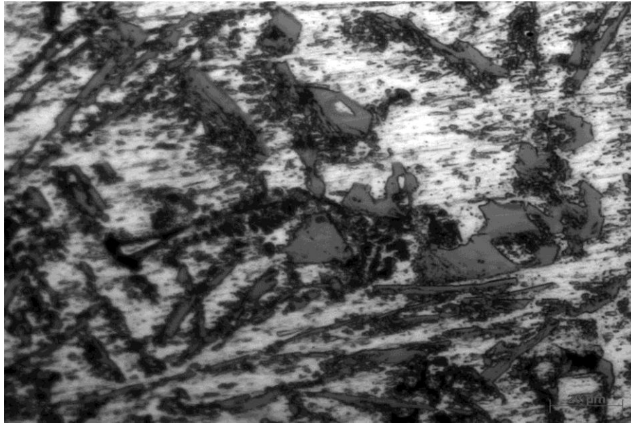
Figure V.17 : Microstructure de l'alliage Si11Cu2 sans traitement thermique
