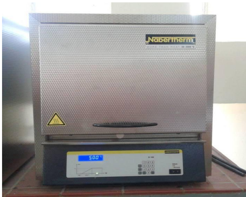
Figure IV.4 : Le four utilisé pour le traitement de mise en solution
