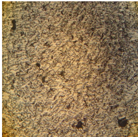
FigureV.11.b : Microstructure de l'alliage Cu2 avec T.T à 490°C trempée à 60°C (106HB) X100
