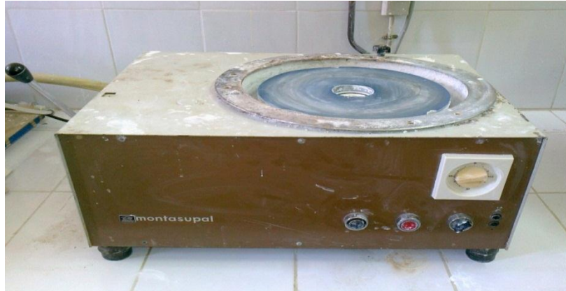
Figure IV.12 : Appareil de polissage de finition
